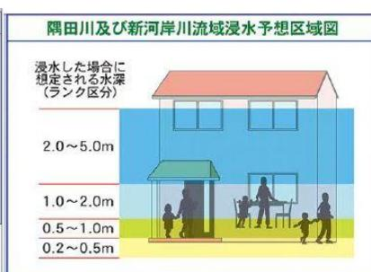
この図は、東京都が平成12年9月に発生した東海豪雨（総雨量589mm、時間最大降雨114mm）の降雨実績により作成した「隅田川及び新河岸川流域浸水予想区域図」を基に、隅田川及び新河岸川が氾濫した場合に想定される浸水区域及び浸水深を示しています。
